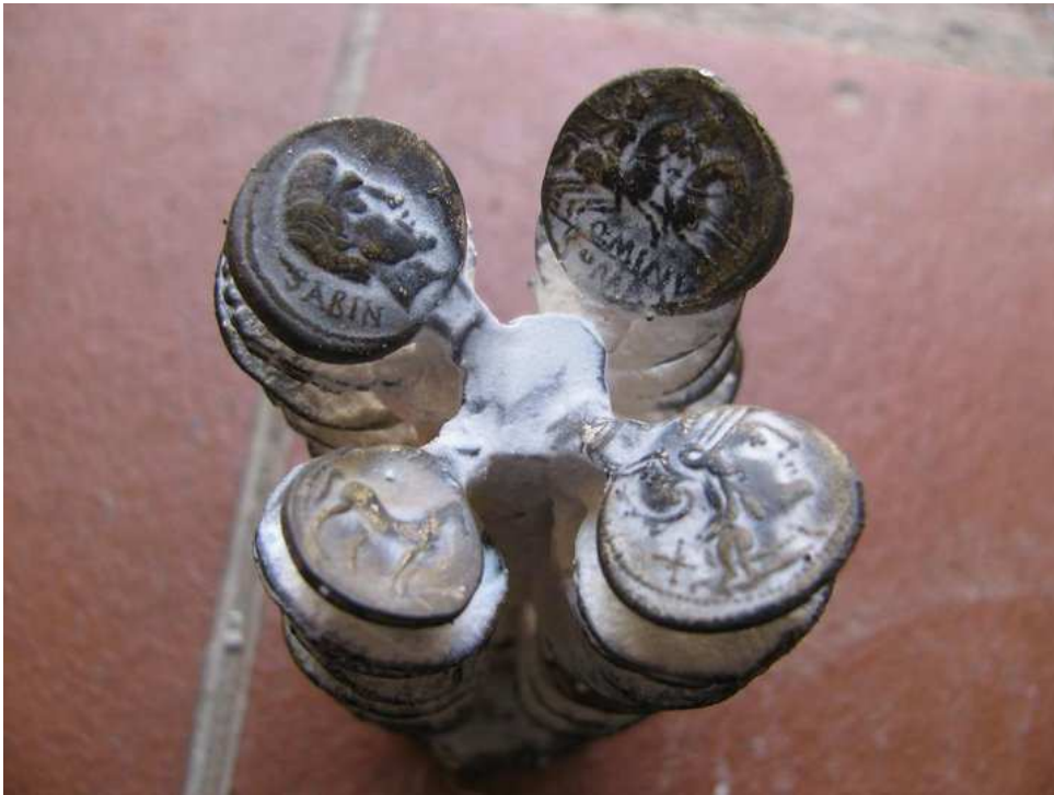
Ilustración 4 - Árbol de fundición con copias de denarios de plata. [REMONEDA]
