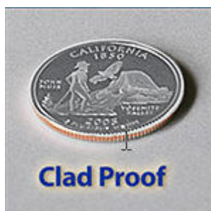
Ilustración 4- Moneda Clad con el canto bicolor (níquel/cobre/níquel)
